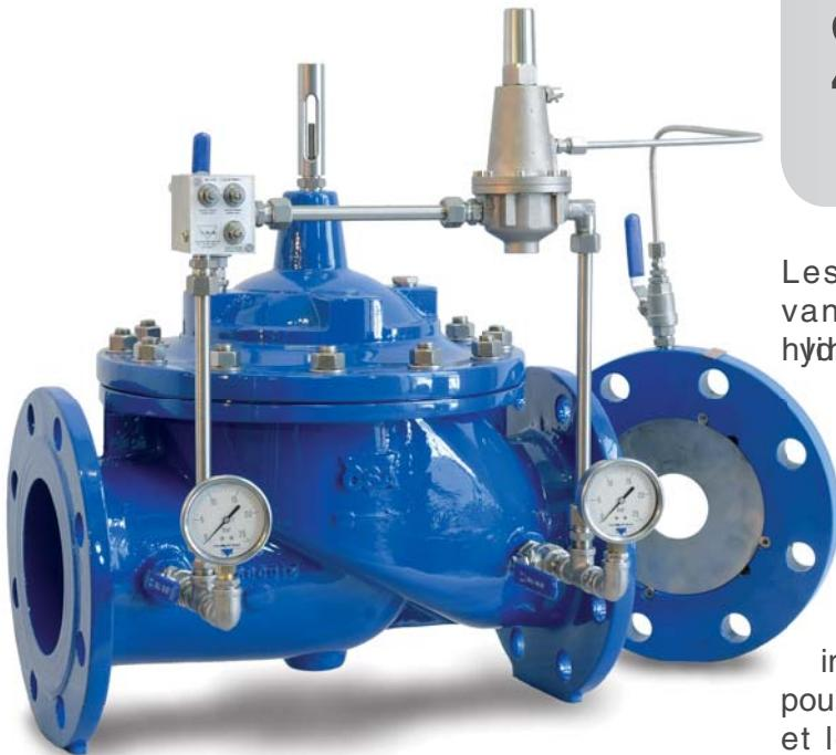
Les vannes XLC 430/330 sont des vannes de régulation à fonctionnement 100% hydraulique qui ébit à une valeur constante indépendamment de la variation de la pression amont. En cas de débit inférieur à la valeur de réglage, la vanne s'ouvre complètement.
